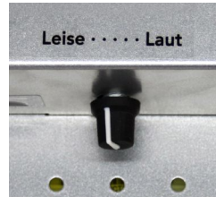
Lautstärke-Drehregler an Kutis Unterseite.
